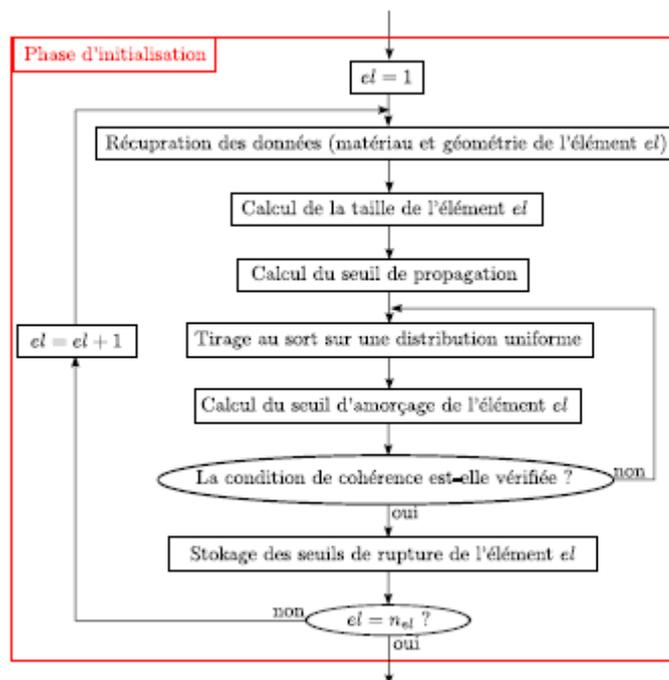
Figure 4.1-a: Schéma d'initialisation du calcul
