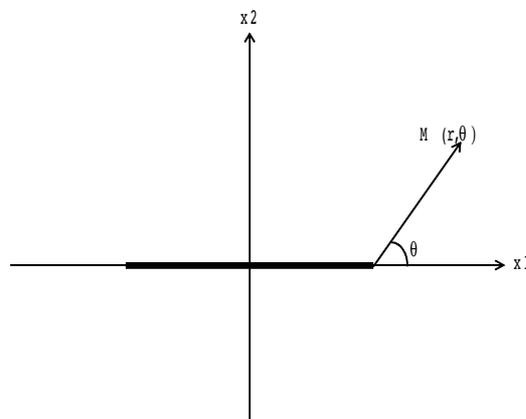
Figure 3.2-a: Définition d'un repère en pointe de fissure
