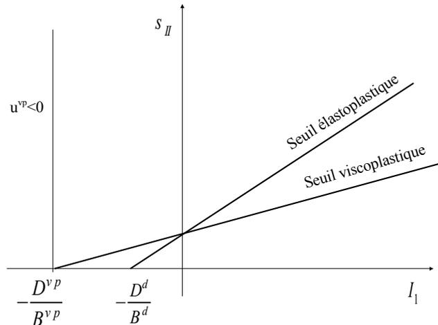
Figure 4.2.3-a. Représentation schématique dans le cas  $u^{vp}(\sigma^e, \xi_{vp}^-) < 0$ ,  $-\frac{D^{vp}}{B^{vp}} < -\frac{D^d}{B^d}$
