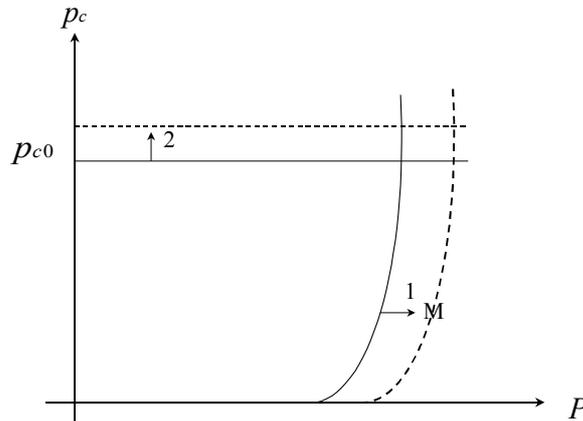
Figure 3.3.5.2-a : Couplage de l'écroissage mécanique à l'écroissage hydrique
