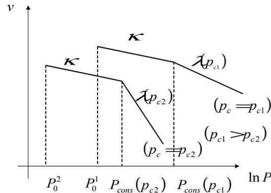
Figure 3.1.1.2-a : Variation du volume spécifique sous chargement oedométrique
