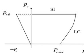
Figure 3.3.2-b : Surface de charge dans l'espace  $(P, p_c)$
