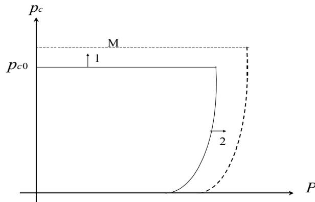
Figure 3.3.5.3-a : Couplage de l'écroûissage hydrique à l'écroûissage mécanique
