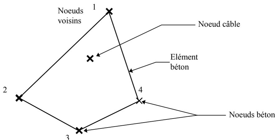
La maille définie par les nœuds 1, 2, 3, 4 contient le nœud câble. Les nœuds voisins sont donc les sommets 1, 2, 3, 4. Si le nœud câble est situé à l'intérieur d'un élément à  $p$  nœuds  $P_1, P_2, \dots, P_n$ , alors les nœuds  $P_1, P_2, \dots, P_n$  sont appelés "nœuds voisins" du nœud câble.
