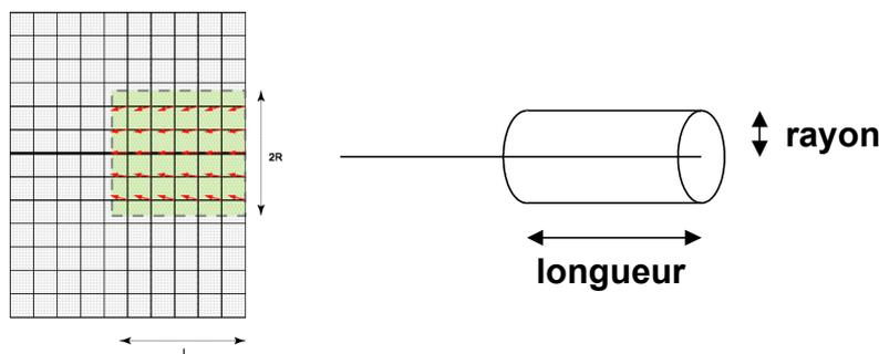
L'identification et la création des relations cinématiques entre les nœuds du béton et du câble se font de façon automatique par la commande `DEFI_CABLE_BP`, où les nouvelles données  $R$  et  $L$  seront à fournir par l'utilisateur.
