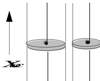
Figure 4.2.2-a : Structures élancées avec contact cercle sur cercle
