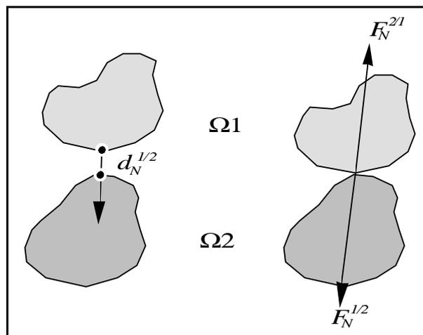
Figure 2.1-a : Distance normale et réaction normale
