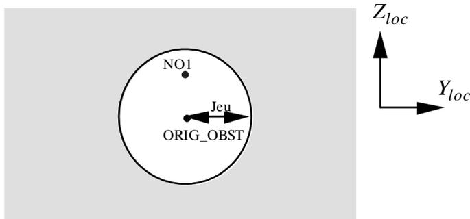
Figure 4.1.2-b : Géométrie de la liaison nœud obstacle circulaire
