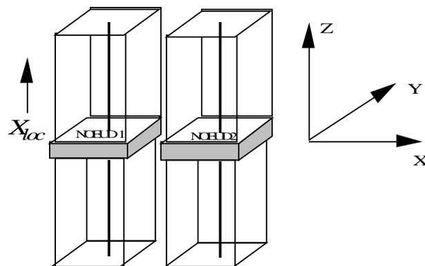
Figure 4.2.1-a : Structures élancées avec contact plan sur plan
