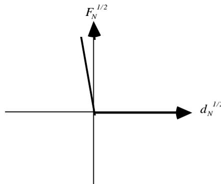
Figure 3.1-a : Graphe de la relation de contact unilatérale approchée par pénalisation
