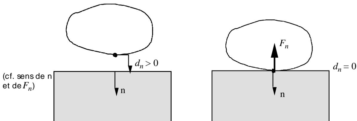
Figure 2.1-c : Distance normale et réaction normale entre une structure et un support
