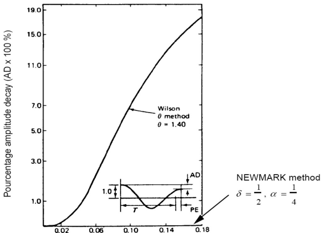
On vérifie ici que l'algorithme de NEWMARK avec ces paramètres ne présente aucun amortissement numérique.
