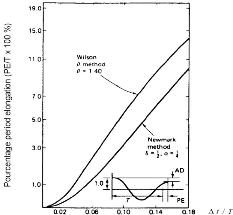
Sur ces 2 graphes, on constate que pour garantir une précision sur l'amplitude et la phase des déplacements calculés, il faut respecter un critère voisin de :
