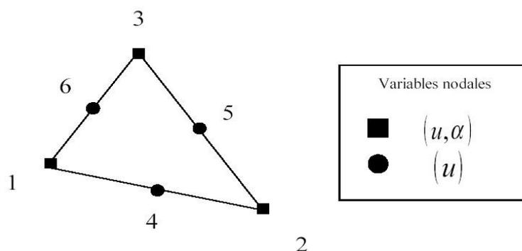
On utilise les familles de points de Gauss des éléments linéaires correspondants, ce qui se traduit par une sous-intégration sur les déplacements. L'utilisation des familles de points de Gauss des éléments quadratiques impliquerait une sur-intégration pour  $\alpha$  provoquant des oscillations intempestives.
