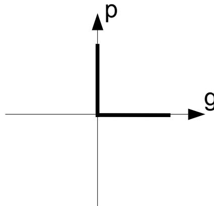
Figure 2.2-b : graphe de la condition de contact unilatéral.
