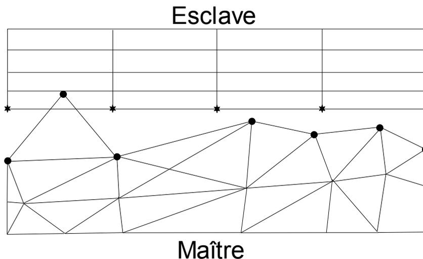
Figure 3.1-a : surface maître et surface esclave.
