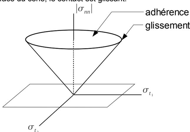
Figure 2.3.4-a : interprétation du cône de frottement.
