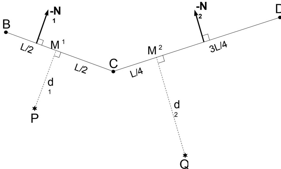
Figure 3.5.1-b : écriture de la matrice de contact  $\mathbf{A}$  sur un exemple.
