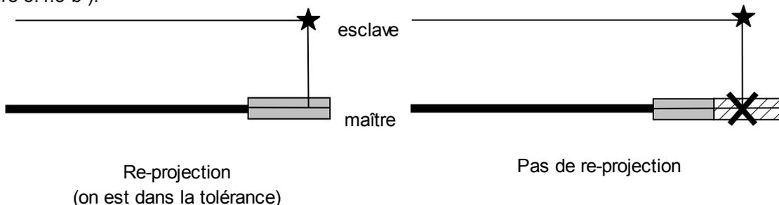
Figure 3.4.5-b : principe de la zone de tolérance pour la projection sur une maille maître.
