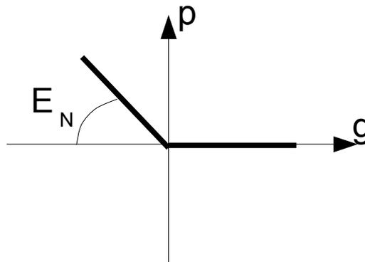
Figure 4.3.3.1-a : régularisation de la condition de contact.
