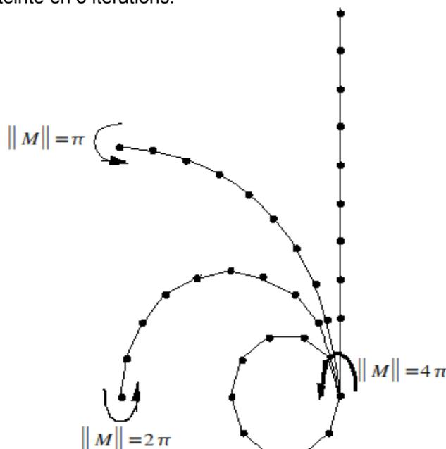
Figure 13.1-a : Poutre soumise à un moment en bout
