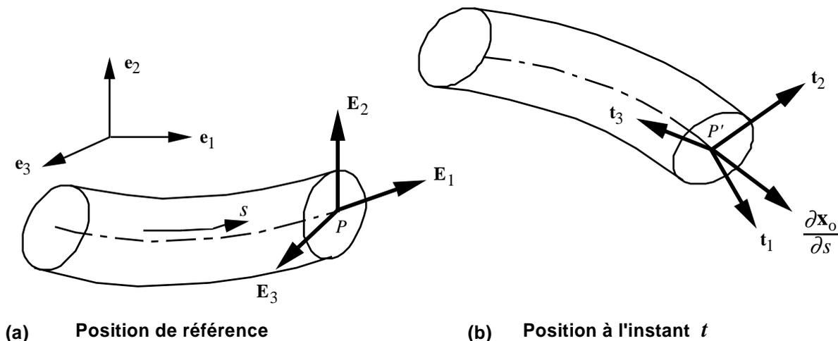
Figure 3-a : Évolution d'un tronçon de poutre
