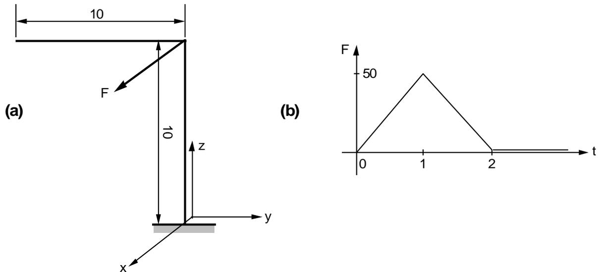
**Figure 13.4-a : Potence soumise à une force dynamique perpendiculaire à son plan**
