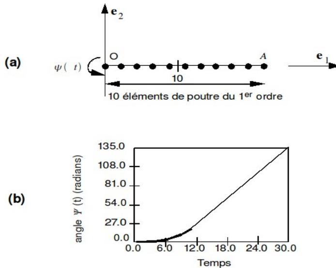
Figure 13.5-a : Bras de robot soumis à une rotation imposée.
