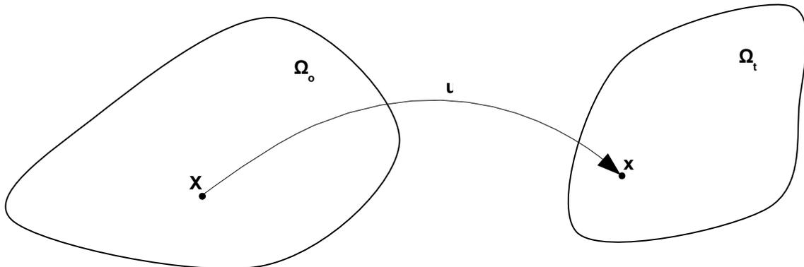
Figure 1.1-1: Transformation de la configuration initiale à finale
