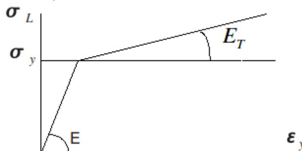
ECRO\_LINE\_FO correspond au cas où  $E_T$  et  $\sigma_y$  dépendent de la température et sont alors calculés pour la température du point de Gauss courant. Le module d'Young  $E$  et le coefficient de Poisson  $\nu$  sont ceux fournis sous les mots clés facteurs ELAS ou ELAS\_FO. Dans ce cas la courbe de traction est la suivante :
