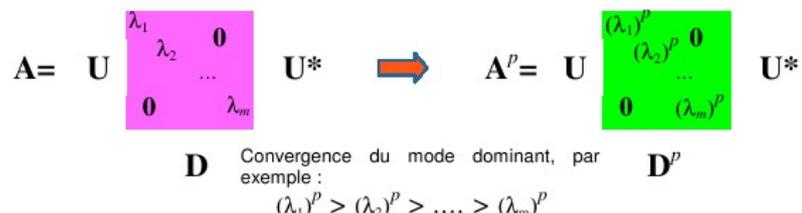
**Figure 2.2-3. Schéma fonctionnel des méthodes de type puissance à partir de la décomposition  $A = UDU^*$  de l'opérateur diagonalisable  $A$  ( $U$  matrice unitaire et  $D$  matrice diagonale des valeurs propres).**
