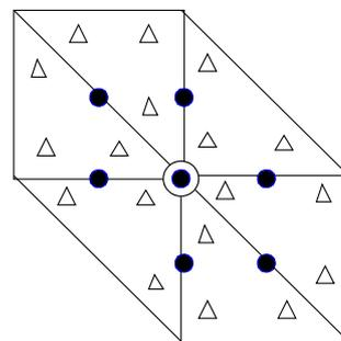
△ points de GAUSS où sont calculées les contraintes  $\sigma_h$  suivant l'équation [éq 2.1-2]
