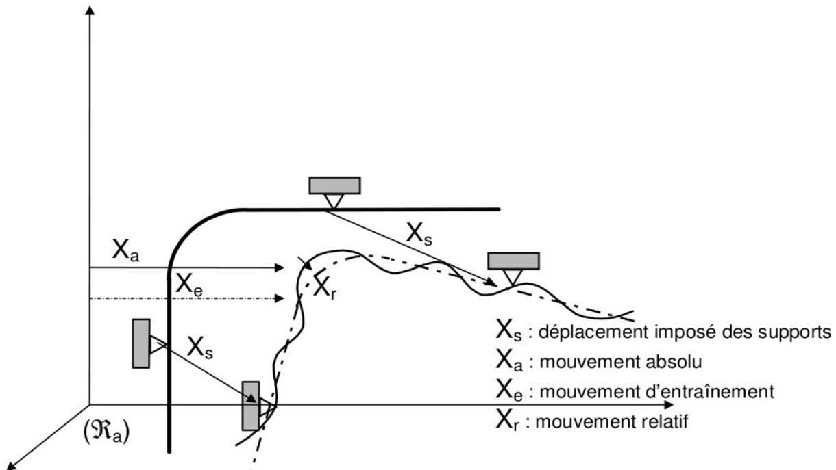
Figure 4.1-a : Décomposition du mouvement des structures
