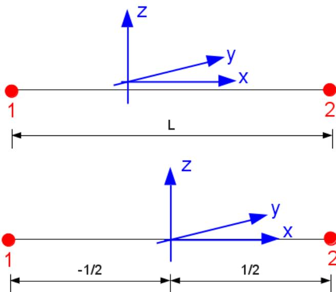
Figure 4.1-a : Élément de référence vs Élément réel.
