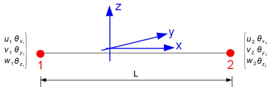
Figure : Élément poutre.
