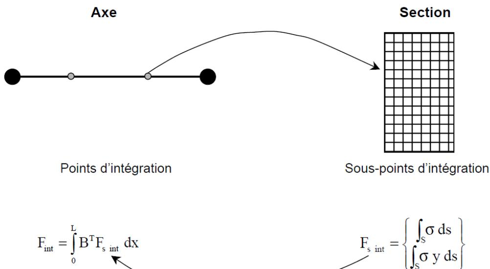
Figure 4.4-a : Poutre multifibre – Calcul de  $\mathbf{F}_{int}$
