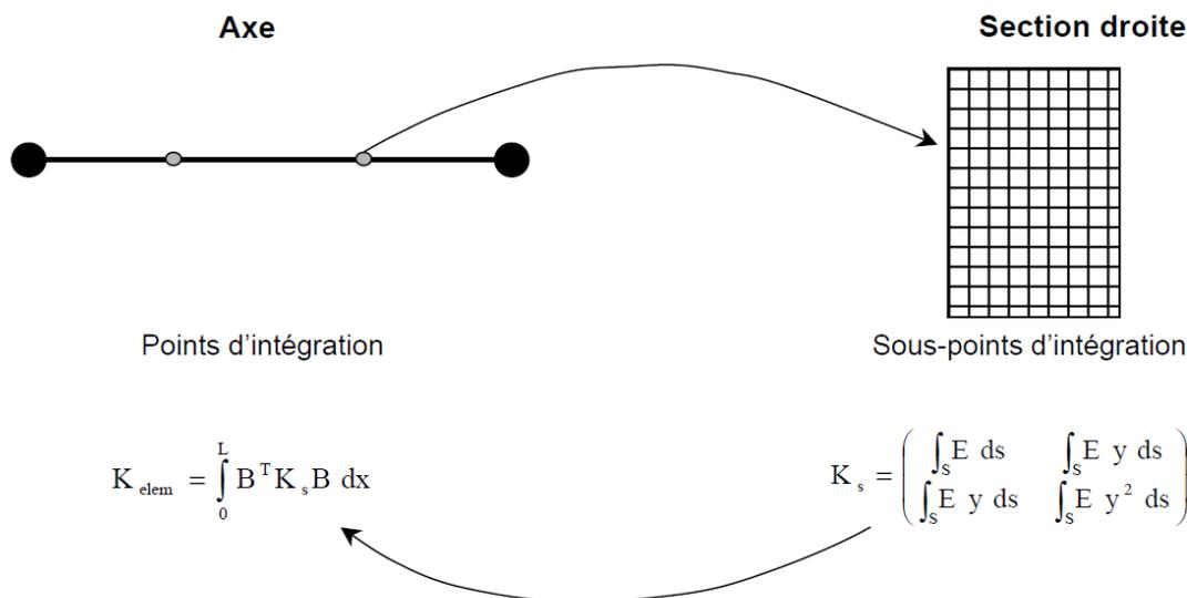
**Figure 4.2.2-a : Poutre multifibre – Calcul de  $\mathbf{K}_{elem}$**
