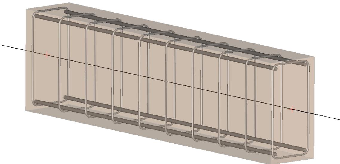
Figure 1-a : Poutre béton armé avec cadres et armatures.
