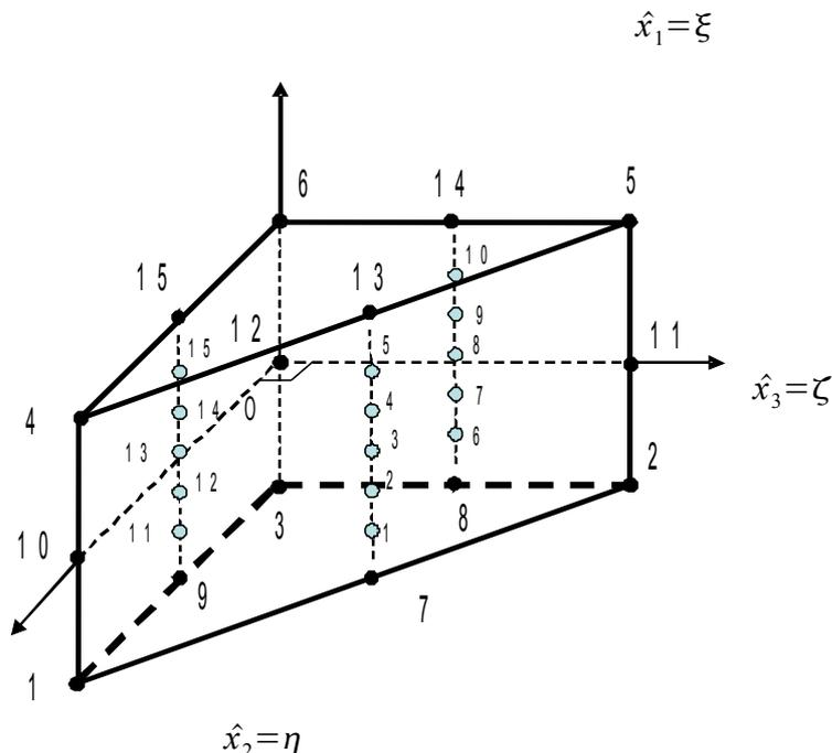
Figure 3.1.1-a . Géométrie de l'élément de référence SHB15 et ses points d'intégration
