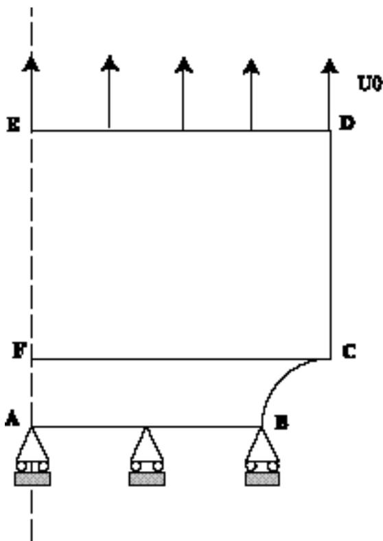
Figure 5.2-a : Géométrie et conditions aux limites
