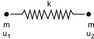
$$\mathbf{K} = \begin{bmatrix} k & -k \\ -k & k \end{bmatrix} \quad \mathbf{M} = \begin{bmatrix} m & 0 \\ 0 & m \end{bmatrix}$$
