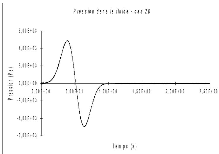
Comme prévu, la largeur du signal mesuré dans les deux cas est identique à celle de la fonction d'excitation. Physiquement, on observe bien la compression due à l'avancée du piston, puis la dépression correspondant à son recul pour revenir à sa position initiale. On note également clairement le retour au repos immédiatement après le passage de l'onde et l'absence de signal réfléchi à l'extrémité du maillage.
