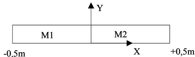
Le matériau  $M1$  sera appelé barrière ouvragée ( $BO$ ) et le matériau  $M2$  barrière géologique ( $BG$ )
