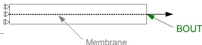
Figure 3: Représentation des nappes d'armature par une membrane
