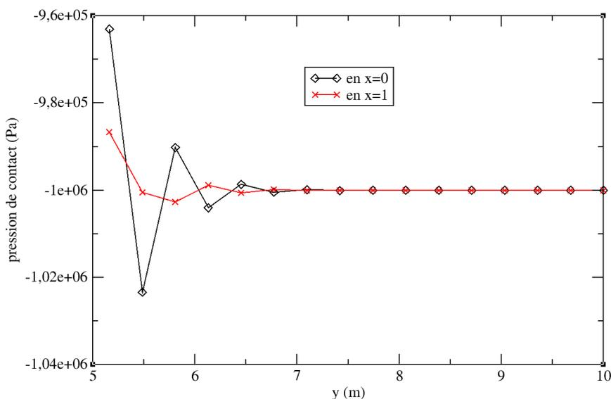
Figure 8.2-8.1.1-a : Évolution de la pression de contact le long de la fissure
