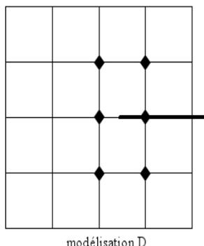
Figure 4.5-5-a : Enrichissement dans une zone proche du fond de fissure
