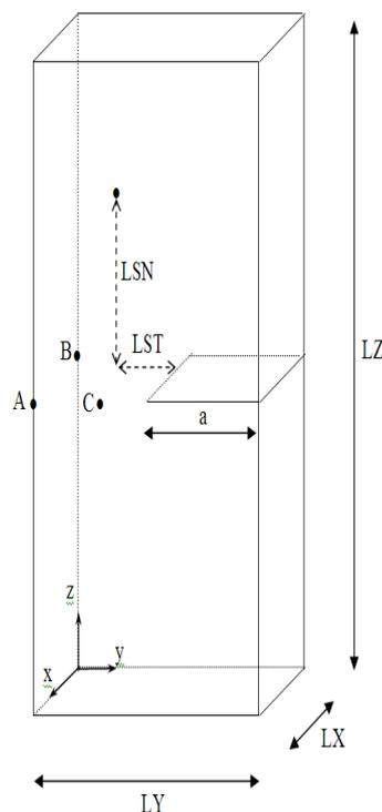
Figure 1.1-a : Géométrie de la plaque fissurée
