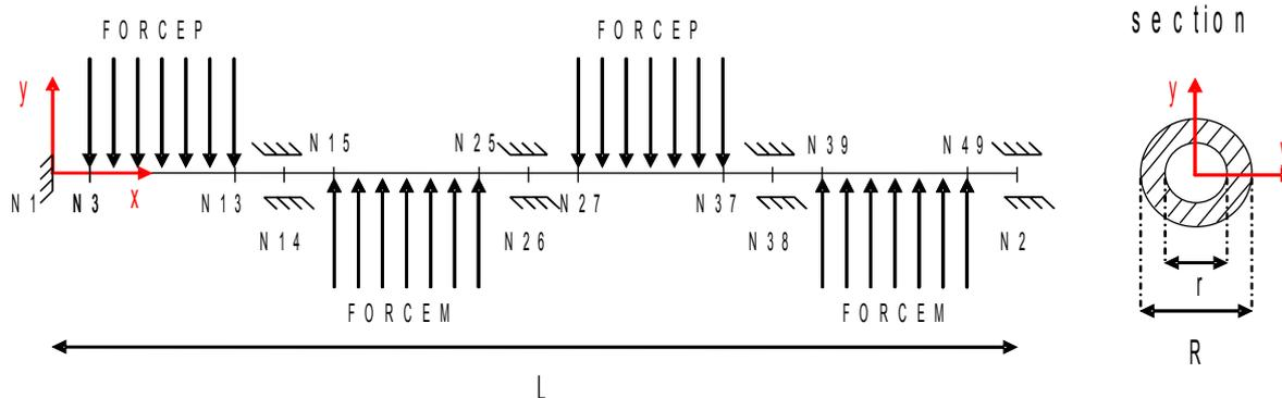
Figure 1.1 Géométrie du problème et système de chargement
