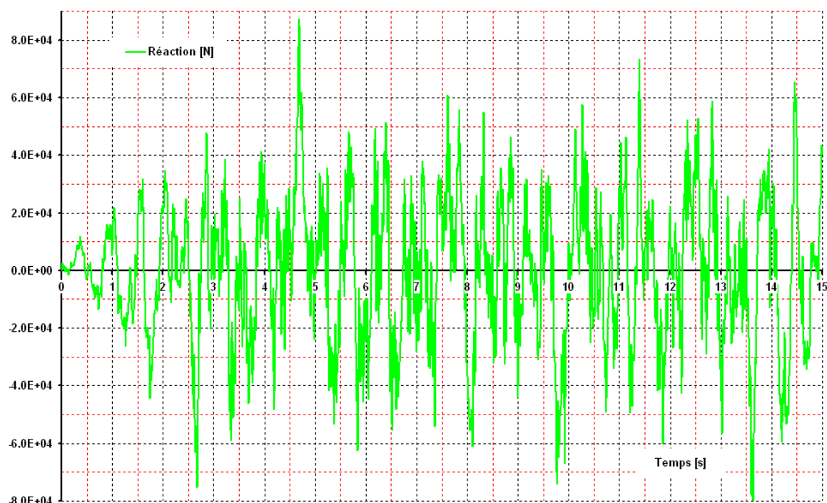
Figure 4.2-d : Réaction appuis A en fonction du temps, pour 15 secondes.
