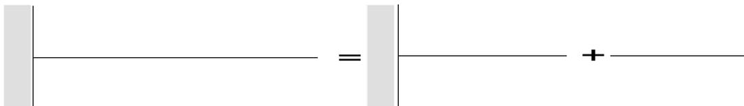
La structure est étudiée à l'aide de la méthode de sous-structuration avec interfaces de type "Craig-Bampton" (interfaces bloquées).
