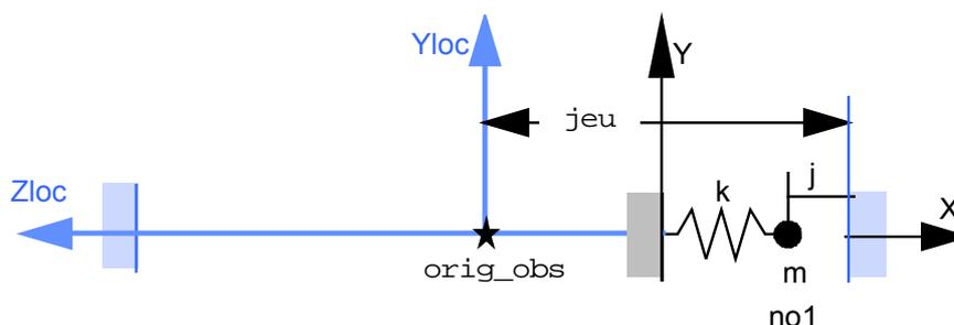
**Figure 3.6.1.6-a : Système masse-ressort impactant une paroi fixe**
