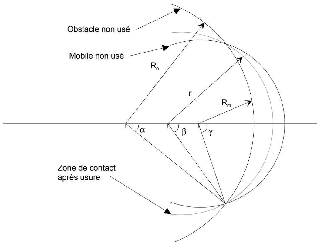
Un solveur numérique intégré au Code\_Aster® permet de résoudre ce système d'équations couplées à 4 inconnues,  $r, \alpha, \beta, \gamma$ . Les profondeurs d'usure sont alors données par les relations suivantes :
