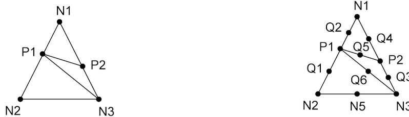
Figure 3.3.6-4 : Cas de découpage linéaire (à gauche) et quadratique (à droite) avec 2 points d'intersection sans sommet
