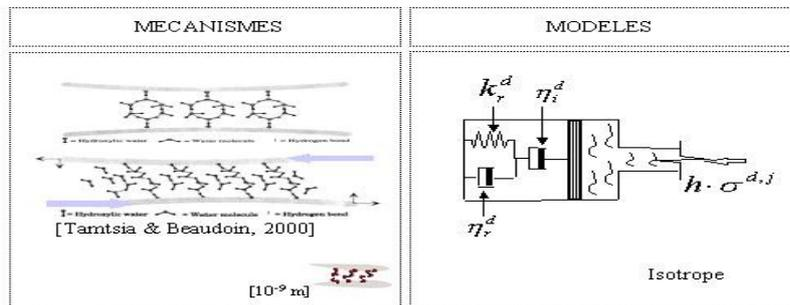
Figure 3.2-a : Modèle phénoménologique associé à la partie déviatorique du fluage propre
