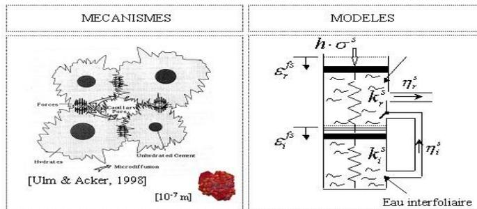
Figure 3.1-a : Modèle phénoménologique associé à la partie sphérique du fluage propre
