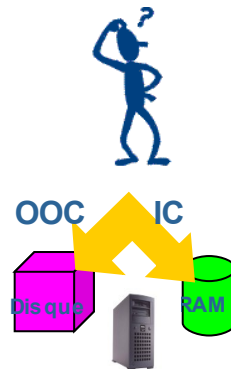
Figure 2.3-2. Deux types de gestion mémoire standards: entièrement en RAM ('IN_CORE') et RAM/disque ('OUT_OF_CORE').
