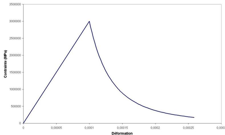
Figure 1 : Réponse contrainte-déformation
