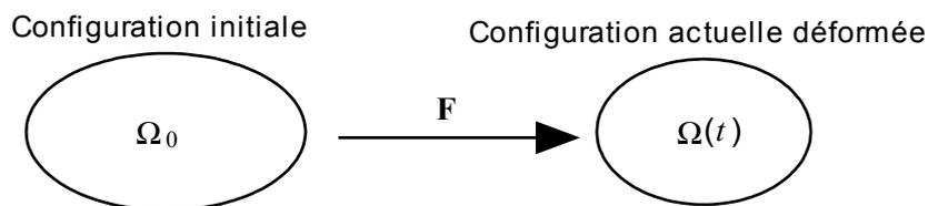
Figure 3.2.1-a : Représentation de la configuration initiale et déformée
