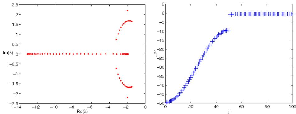
Figure 2.2-2. Exemples du spectre d'un QEP ( $n=50$ ) d'un système masses-ressorts amorti [TM01]. Figure de gauche, on est dans le cas n°5 du tableau 2.2-1. Celle de droite, on rajoute la contrainte de sur-amortissement et le spectre devient réel négatif en deux paquets (cas n°6).
